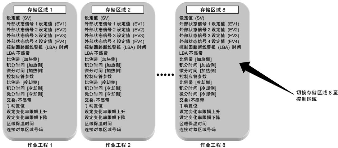
并且, 通过使存储区域间相互连接, 可以进行简易程序的运行。每 1 个通道最大可以进行 16 段 (8 步) 的程序运行。
