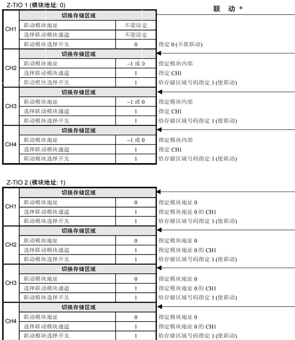
\* 上述例的情况, 变更模块地址 0 的 CH1 的存储区域号码 (RKC 通信识别符: ZA、MODBUS 地址: 006EH), 则指定了联动的通道的存储区域号码被批量切换。
