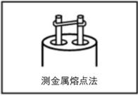
另外，如果将金属 C 的部分看作测温点，也可以将其视为热电偶，它可以通过在恒定温度下与金属接触来测量温度。例如校准热电偶，将热电偶插入高温熔化金属钨等，就是利用了这个方法，通常称为测金属熔点法（或金属丝法）。
