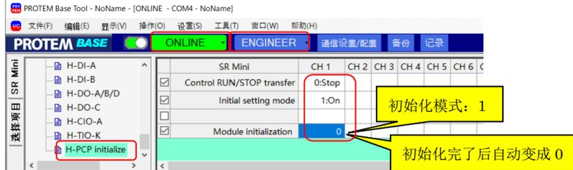
7.将控制器运行/停止设置为 1，退出初始化。
