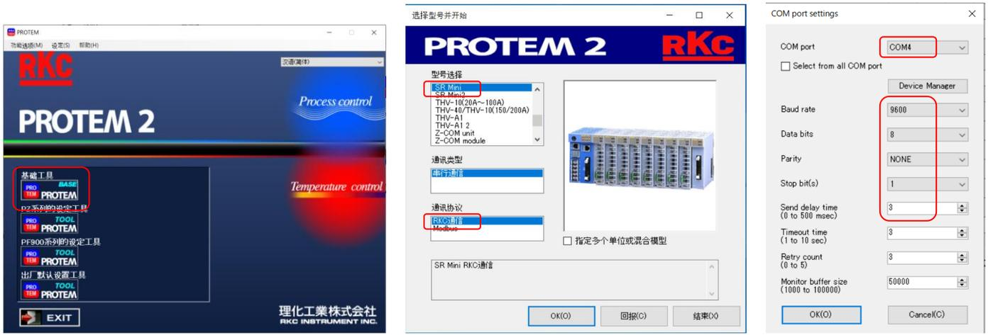
3.选择 COM 端口和设置通信参数（上图右）。设置端口与电脑中的 COM 端口一致，本例为 COM4。如果不清楚的话，可以单击 Device Manager 确认。
