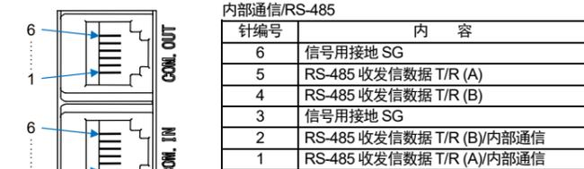
接续 J-TI 和主计算机时，可使用本公司制造的通信电缆 W-CF-C01-AY3 (另售)。此外，接续 J-TI 和 J-TI 时，可使用本公司制造的通信电缆 W-BF-02\* (另售)。\* 电缆的屏蔽线与 J-TI 的 SG (6 号针) 接续。
