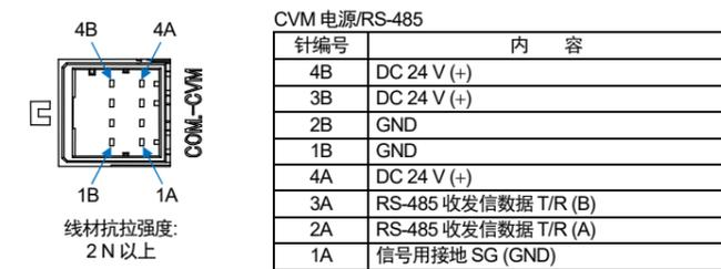
请使用屏蔽线接续 J-CVM，屏蔽线应切实接地。
