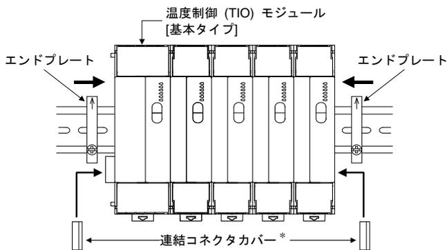
\* コネクタ接点保護のため、連結コネクタカバーを、両端のモジュールに取り付けてください。
