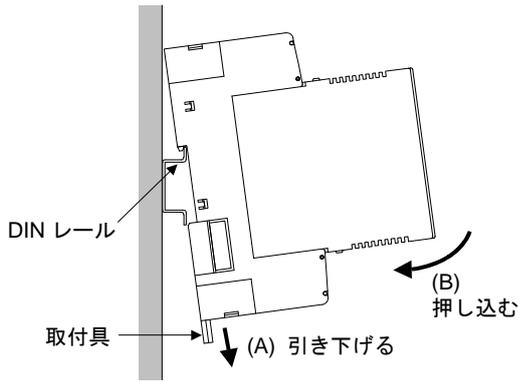
2. 取付具を上を押し込んで、DIN レールから外れないようにロックします。
