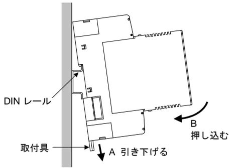
2. 取付具を上押し込んで、DIN レールから外れないようにロックします。
