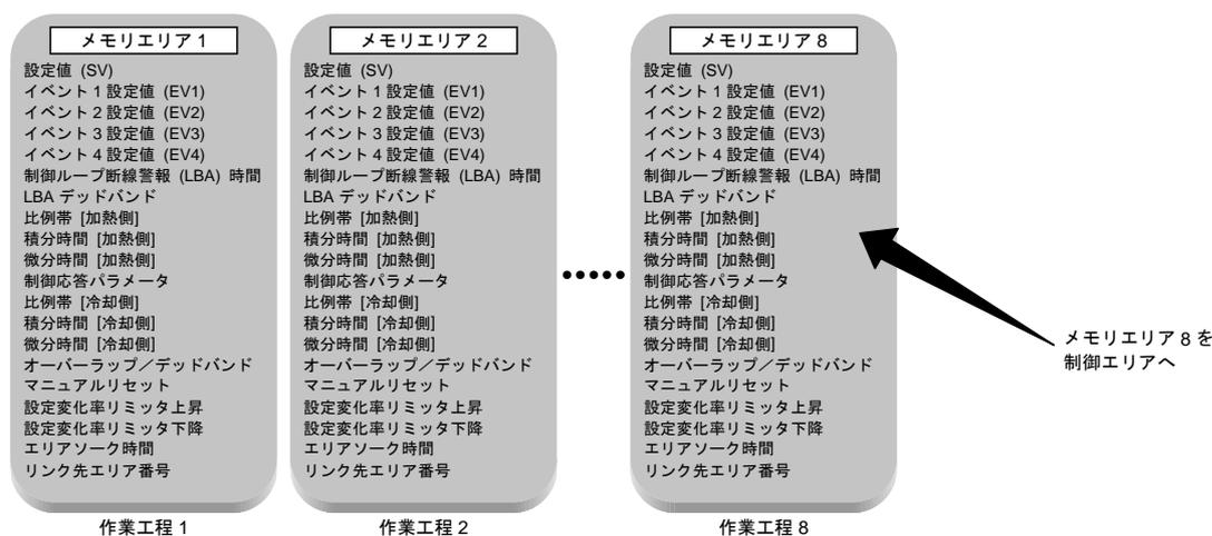
また、メモリエリアどうしをリンクさせることで、簡易プログラム運転ができます。1 チャンネルにつき、最大 16 セグメント (8 ステップ) のプログラム運転ができます。
