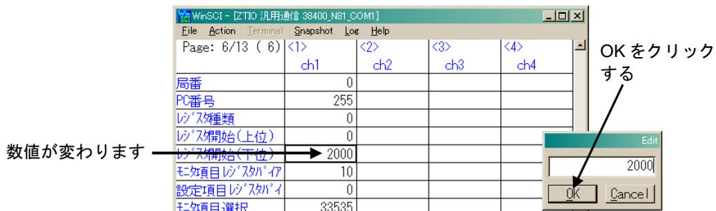
5. PLC 通信環境の設定に続いて、Z-TIO-C モジュール 1 のエンジニアリングデータや運転データなどを設定します。
