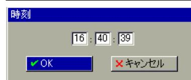
5. 変更がなければ「キャンセル」、変更したならば「OK」を選択します。画面は、コンフィグレーションの「画面」で設定した「リセット後の画面」(出荷値: 折れ線グラフ) になります。
