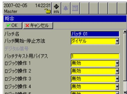
4. 「バッチ開始・停止方法」を選択すると、バッチ開始・停止方法のメニューが表示されるので、「デジタル信号」を選択します。
