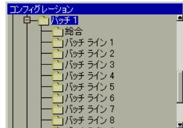
3. 「総合」を選択すると、バッチ 1 設定の画面が表示されます。ここで、バッチ開始およびデジタル信号について設定します。
