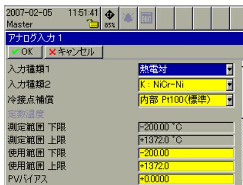
3. 「入力種類 1」を選択すると、入力種類のメニューが表示されるので、その中から「熱電対」を選択します。
