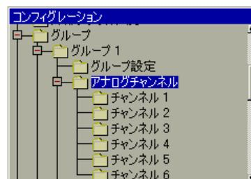
5. チャンネル 1 にアナログ入力 (AI) 1 を割り付けるために、「チャンネル 1」を選択して、チャンネル 1 の設定画面を表示させます。
