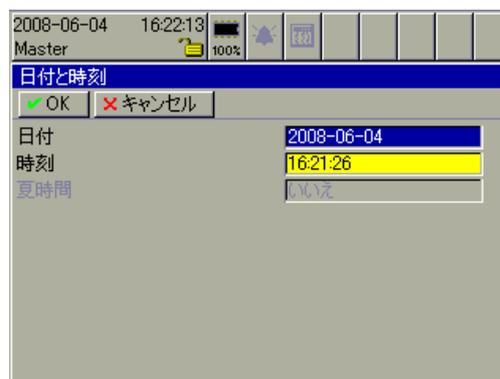
4. 「日付」と「時刻」を確認し、現在の日時と異なる場合は正しい日時に変更します。変更する欄にカーソルを移動してダイヤルを押すと、設定画面が表示されるので、正しい日付または時刻に設定します。
