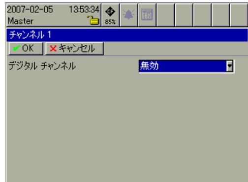
9. 「デジタルチャンネル」を選択すると、チャンネル1に割り付ける信号のメニューが表示されるので、「デジタル入出力 09」を選択します。以上でこの画面の設定は終了なので、「OK」を選択します。画面はコンフィギュレーションのメニューに戻ります。
