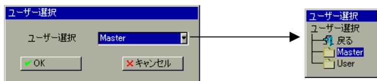
ユーザーを選択したら、カーソルを **OK** に移動してダイヤルを押すと、パスワード入力ウィンドウが表示されます。ダイヤルを回してパスワードを選んで押します。選択された数字は「\*」と表示されます。
