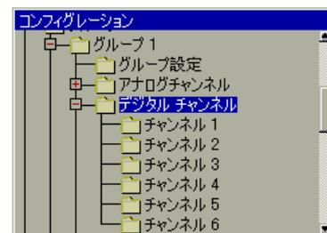
8. チャンネル1にデジタル入出力 (DIO) 9を割り付けるために、「チャンネル1」を選択して、チャンネル1の設定画面を表示させます。
