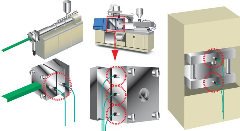
プレス機/押出成形機/射出成形機金型の温度監視
