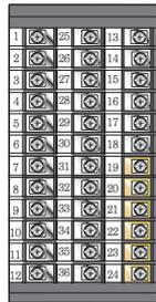
※ 圧着端子は全て幅6mm以下のM3用圧着端子をご使用ください。
