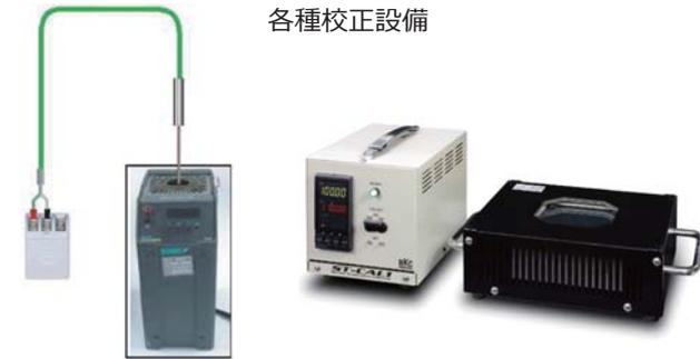
NWS-Mini 校正用電気炉
