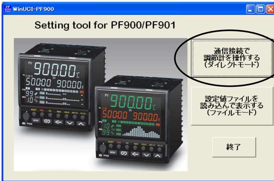
3. 「通信パラメータ指定」画面が表示されます。通信パラメータを PF900/PF901 と同じ値に設定してから、[OK] ボタンをクリックします。
