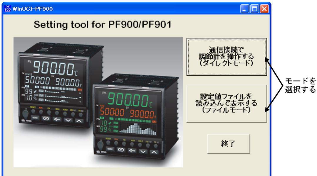
**ダイレクトモード:** 通信で接続して、PF900/PF901 のデータをモニタしたり、変更したりする場合に選択します。PF900/PF901 をパソコンに接続してから、[ダイレクトモード] ボタンをクリックしてください。
