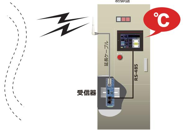
汎用の温度センサ（熱電対・測温抵抗体）を接続し手軽に無線測定ができます。
