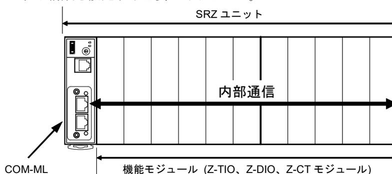
Z-TIO モジュールのアドレスを設定すると、通信上の温度制御チャンネル番号が決定します。
