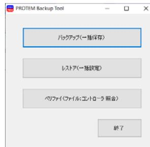
計器内の設定データをパソコンにバックアップ/レストアが可能。計器交換・複製時に便利です。
