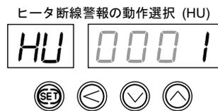
8. 変曲点の操作出力値と電流値を確認する場合は、SET キーを押して表示を切り換えます。変曲点 3 点のうち、操作出力値が小さい変曲点から、変曲点の操作出力値と変曲点の電流値が自動設定されています。
