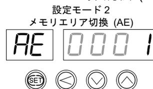
2. 非直線性抵抗対応ヒータ断線警報は、メモリエリア機能には対応していませんので、メモリエリアの選択は不要です。メモリエリア1で使用してください。
