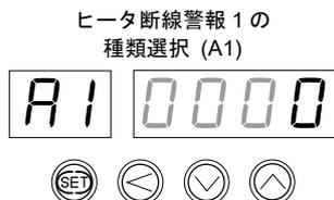
11. SET キーを押して、ヒータ断線警報 2 遅延回数の設定 (n2) に切り換えます。
