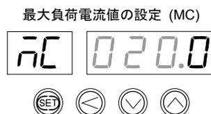
5. SET キーを押して、ヒータ断線警報 1 設定値の設定 (H1) に切り換えます。
