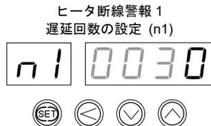
9. SET キーを押して、ヒータ断線警報 1 の種類選択 (A1) に切り換えます。
