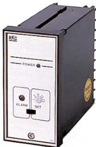
ヒータ断線警報器は、ヒータに流れる電流値を電流検出器で監視し、ヒータ断線時に接点で出力する機器です。
