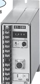
盤内組込型のストレインゲージ式圧力センサの出力変換器です。PCT-300と同様に最大4点の測定出力が可能で、ゲイン設定やゼロ調整は、前面のスイッチで簡単に設定できます。
