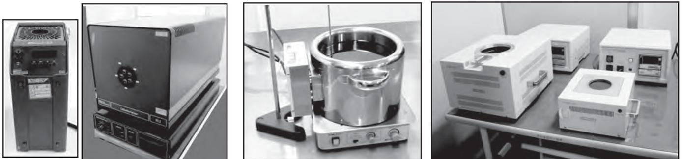
校正用電気炉
