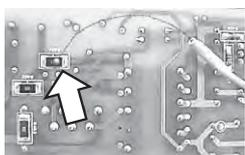
リフロー時の電子部品温度測定例
