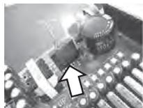
電子部品の実働発熱温度測定例
