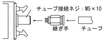
継ぎ手：推奨品：ワンタッチ継手PC6-M5SUS(株式会社日本ビスコ製)
