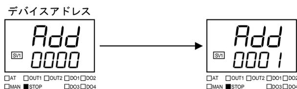
MODBUS 時は、デバイスアドレス 0 は設定できませんので、「1」に自動変換されます。
