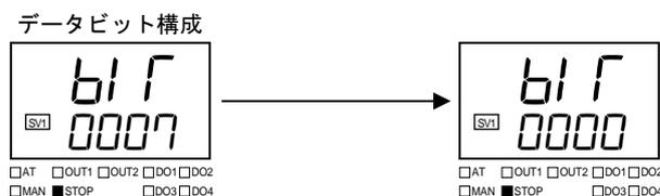
MODBUS 時は、データ 7 ビットは選択できませんので、「0 (データ 8 ビット、パリティなし、ストップ 1 ビット)」に自動変換されます。
