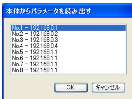
この場合、No.1 を選択して **OK** を押すと、レコーダ本体で設定したパラメータをパラメータローダに読み出します。
